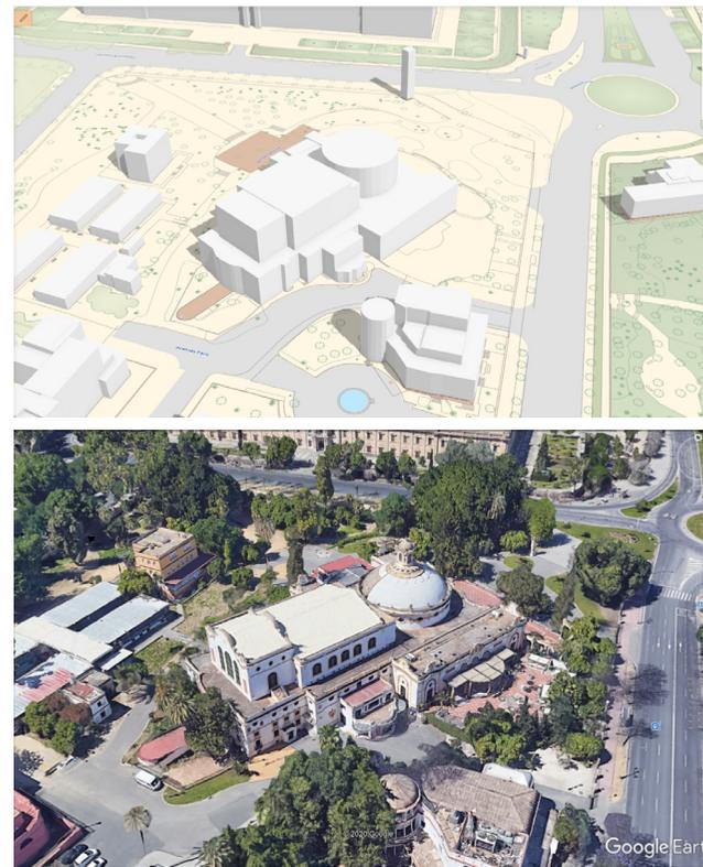
Figura 4: Teatro Lope de Vega y Casino de la Exposición. Ejemplo de edificio modelado con nivel de detalle LOD1 en el modelo 3D-GIS creado por ide.SEVILLA: a) Vista del modelo 3D-GIS; b) Vista aérea real del edificio.
