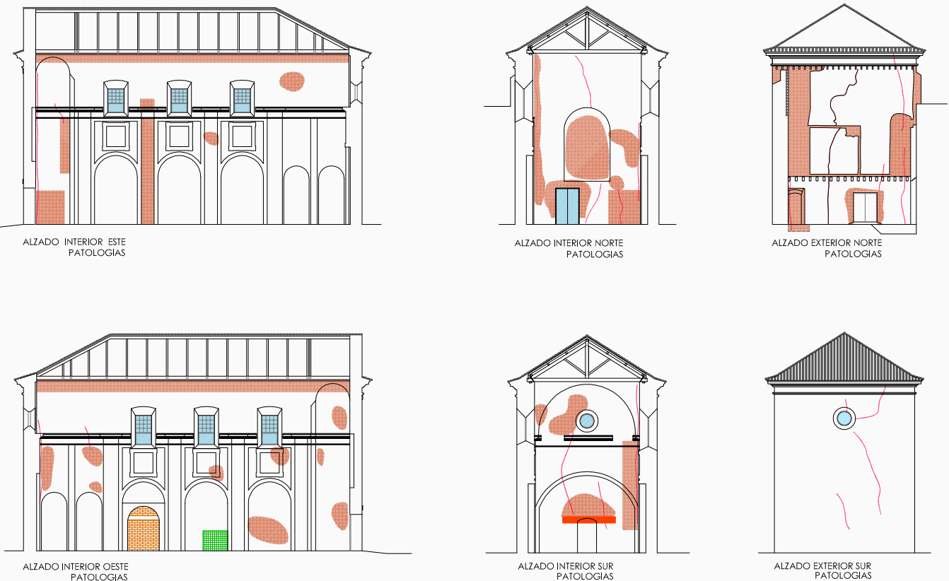
PATOLOGIAS EN EL EDIFICIO
